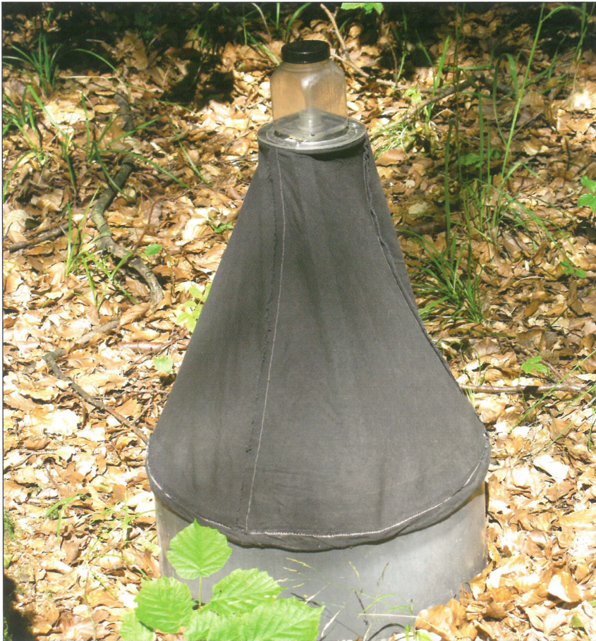
Figur 1. Klækkefælde forsynet med udskiftelig fangdåse i toppen. Fangdåsen indeholder en 2% formalinopløsning (konserveringsvæske) tilsat sulfosæbe (afspændingsmiddel). Foto: Lise Brunberg Nielsen.
